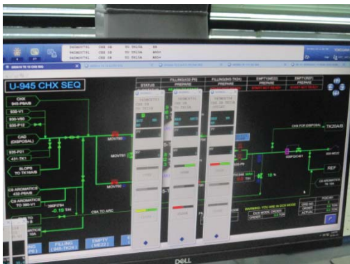
รูปที่ 3.1-1 (รูปที่ 92 หน้าจอ DCS ระบบ วาล์วปิด-เปิดอัตโนมัติ On-Off Valve)
