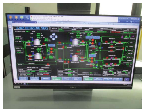
รูปที่ 3.1-1 (รูปที่ 68 หน้าจอ ATG แสดง สัญญาณ Alarm ที่ระดับต่างๆ เพื่อป้องกัน การล้นถังของผลิตภัณฑ์)
