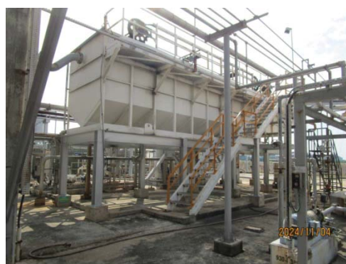
รูปที่ 3.1-1 (รูปที่ 22 Dissolved Air Floation (DAF))
